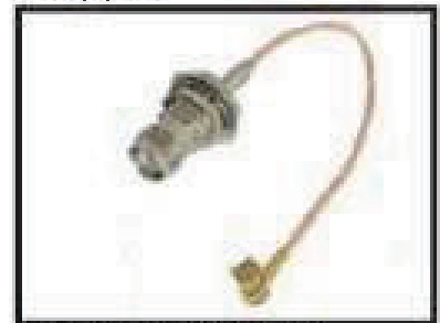
Item No. : Q142043030 RF CABLE ASS'Y (RG178/U,L=160MM) MMCX(M) R/A / SMA(F)
